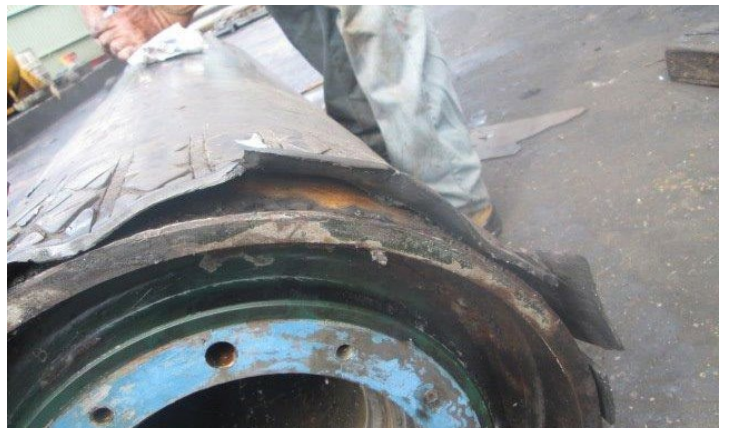
Lagging edge lifting
