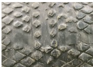
6MW Drive NSW, Australia. Desintegración de caucho
